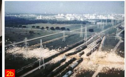
**Incidente 2:** Observou-se que um vagão tanque contendo ácido metacrílico bruto (MAA) estava quente e liberando material através de sua válvula de alívio. A área foi evacuada e após algum tempo o tanque explodiu, destruindo-o e causando danos significativos na área (Figuras 2a e 2b). Como as pessoas tinham sido evacuadas, ninguém se feriu.
