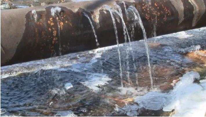
Uma empresa decidiu deixar de fabricar um produto químico. Uma das matérias primas era o tricloreto de fósforo ( $PCl_3$ ), tóxico e corrosivo. As tubulações para o tanque de armazenagem e para o processo foram limpas de  $PCl_3$ . Alguns anos mais tarde, um operador detetou um vazamento no exterior. A investigação descobriu que o vazamento tinha origem na tubulação “vazia” de  $PCl_3$ . Não houve danos pessoais e o vazamento foi contido.
